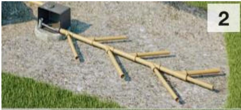
(esempio di impianto di sub-irrigazione)
