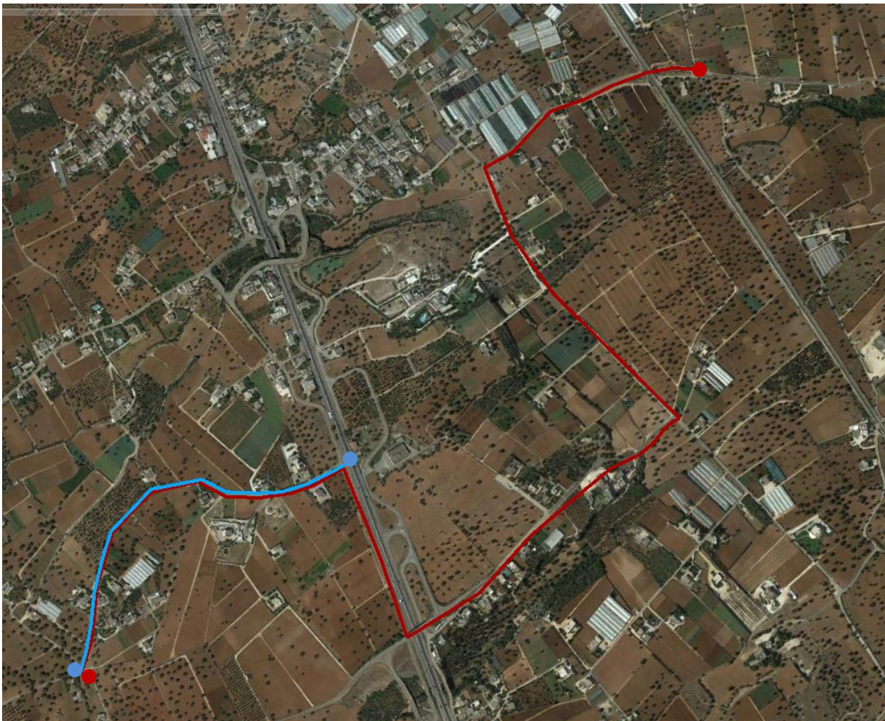
Fig. 01 - Tracciato condotta idrica (azzurro) e fognatura (rosso)
